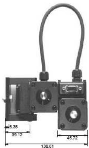
Figura 3.11: Medidas del dispositivo apuntador
